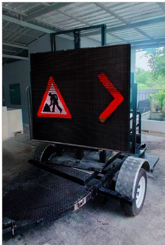
รูปที่ 2.4-13 ลักษณะป้ายเปลี่ยนข้อความได้สำหรับปฏิบัติการบนทางหลวงแบบมีล้อลากจูง (Mobile Variable Message Signs: MVMS)
