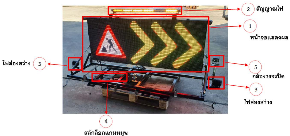
รูปที่ 2.4-10 ลักษณะระบบป้ายประกาศข้อความที่เปลี่ยนแปลงได้ (Portable Variable Message Sign: PVMS)
